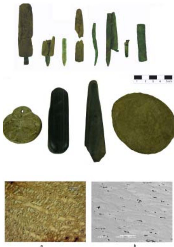
Figura 34. Conjunto de herramientas para técnicas decorativas de orfebrería registradas en la tumba M-U 725. a) Observación en microscopía óptica tras un ataque químico de la muestra del cincel M7. Microestructura dendrítica típica de vaciado. b) Observación en MEB. La forma alargada de los poros y de las dendritas así como la presencia de numerosas líneas de deslizamiento observadas al nivel del filo indican que el cincel de cobre arsenical (97,2% Cu y 2,8% As) fue elaborado a partir de un esbozo vaciado en un molde. Se finalizó la fabricación martillando la parte activa para darle más dureza y resistencia.
